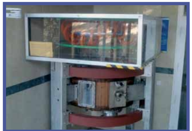
Dos modelos de reactor: Tokamak (abajo) y Stellerator (arriba)
